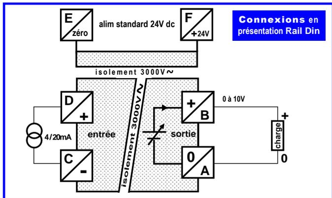
Ce mini-module à triple isolement (3000V~) convertit en volts avec précision, les signaux "4 à 20mA" appliqués sur son entrée
